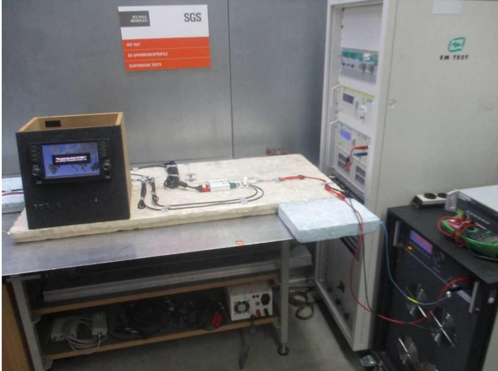
Testaufbau für Puls-Immunity, Pulse 2b, 4 / test setup for pulse immunity, pulses 2b, 4
