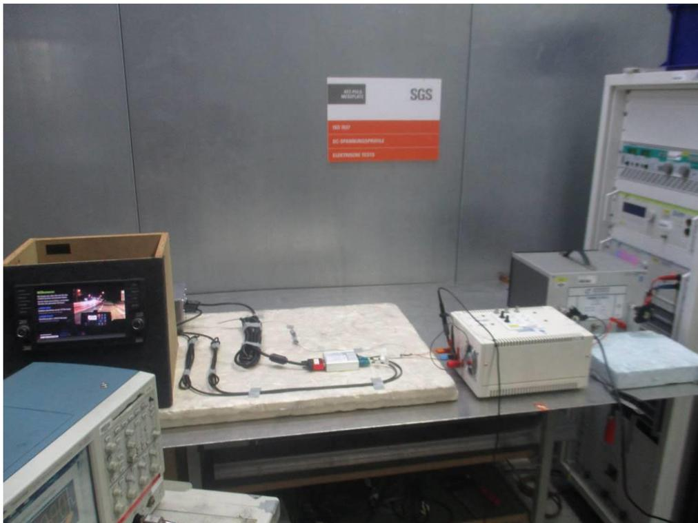
Testaufbau für Puls-Emission (schnelle Pulse) / test setup for pulse emission (fast pulses)
