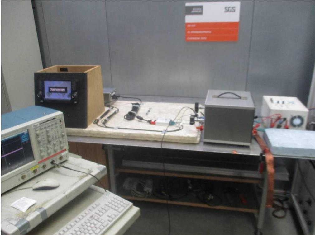
Testaufbau für Puls-Emission (langsame Pulse) / test setup for pulse emission (slow pulses)
